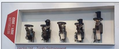
L'extension de la gamme d'unités auxiliaires UAI permet aux plasturgistes d'étendre les possibilités de leurs presses en multi-injection.
