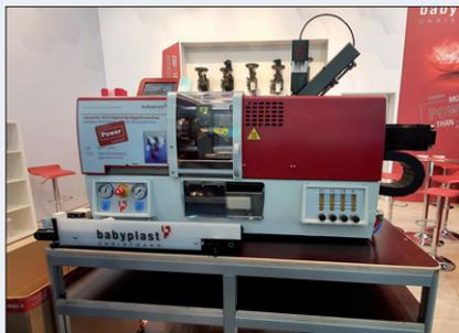
La nouvelle configuration hybride, injection électrique, fermeture hydraulique, répond parfaitement à la demande des plasturgistes.
